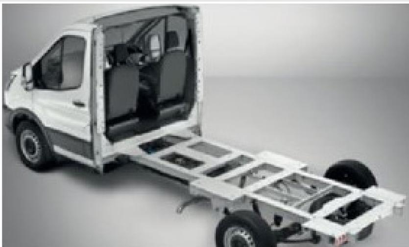
Esta SVO foi desenvolvida para clientes que requerem as vantagens do chão baixo da Transit Skeletal Chassis Cabina, com a vantagem adicional das coberturas do tejadilho fechado e do pilar B. Maior flexibilidade na adição de um separador de carga / painel traseiro para se adequar ao tipo de conversão. Permite conversões mais eficientes no chassis cabina skeletal.
