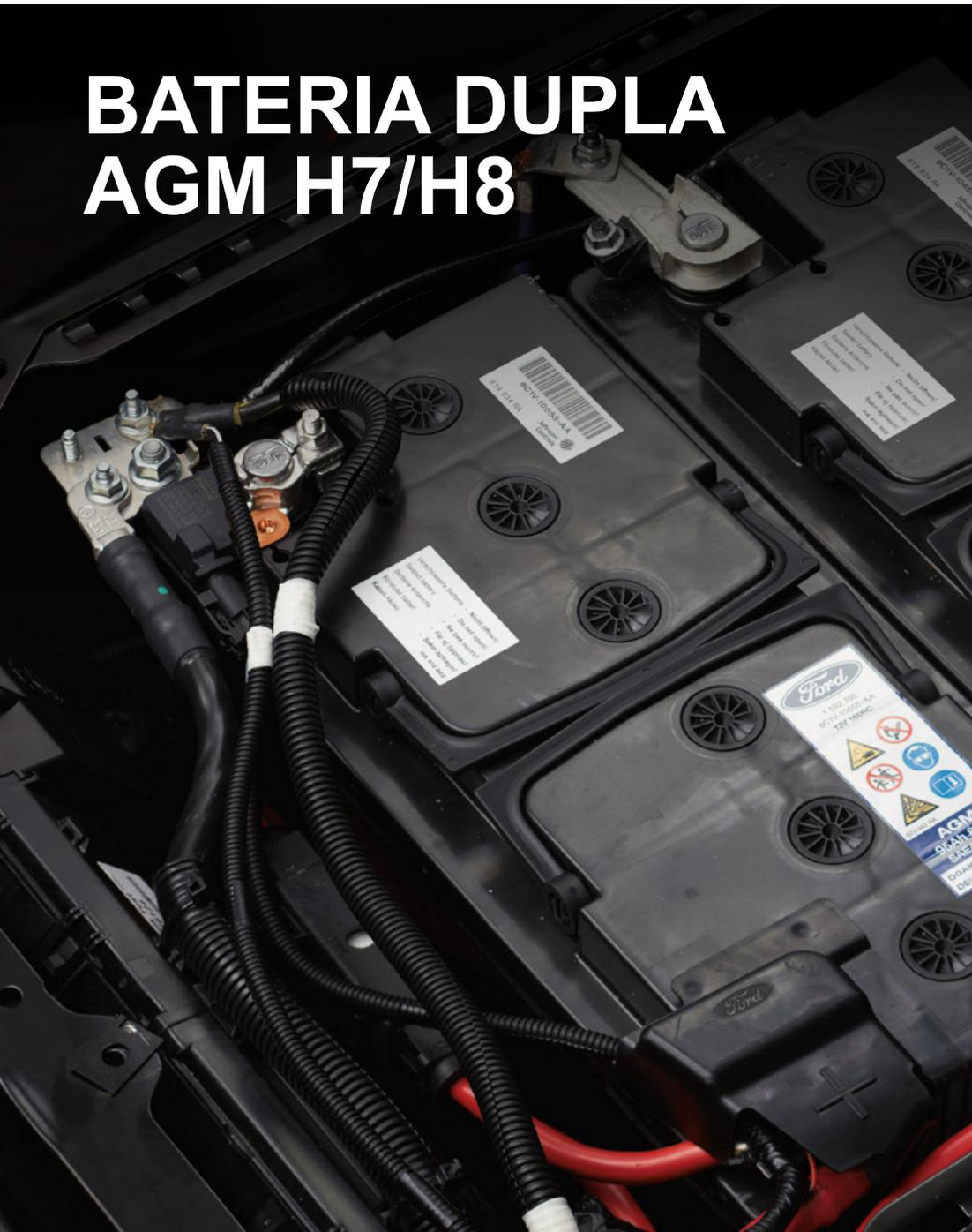
A tecnologia AGM (Absorbent Glass Mat ou separadores de fibra de vidro absorventes) permite que as baterias duplas AGM H7/H8 alimentem equipamento auxiliar que exija um consumo de corrente constante quando o veículo não está a funcionar, ou um consumo de alta carga e curta duração, sobretudo quando o veículo estiver ao ralenti ou com o motor desligado.
