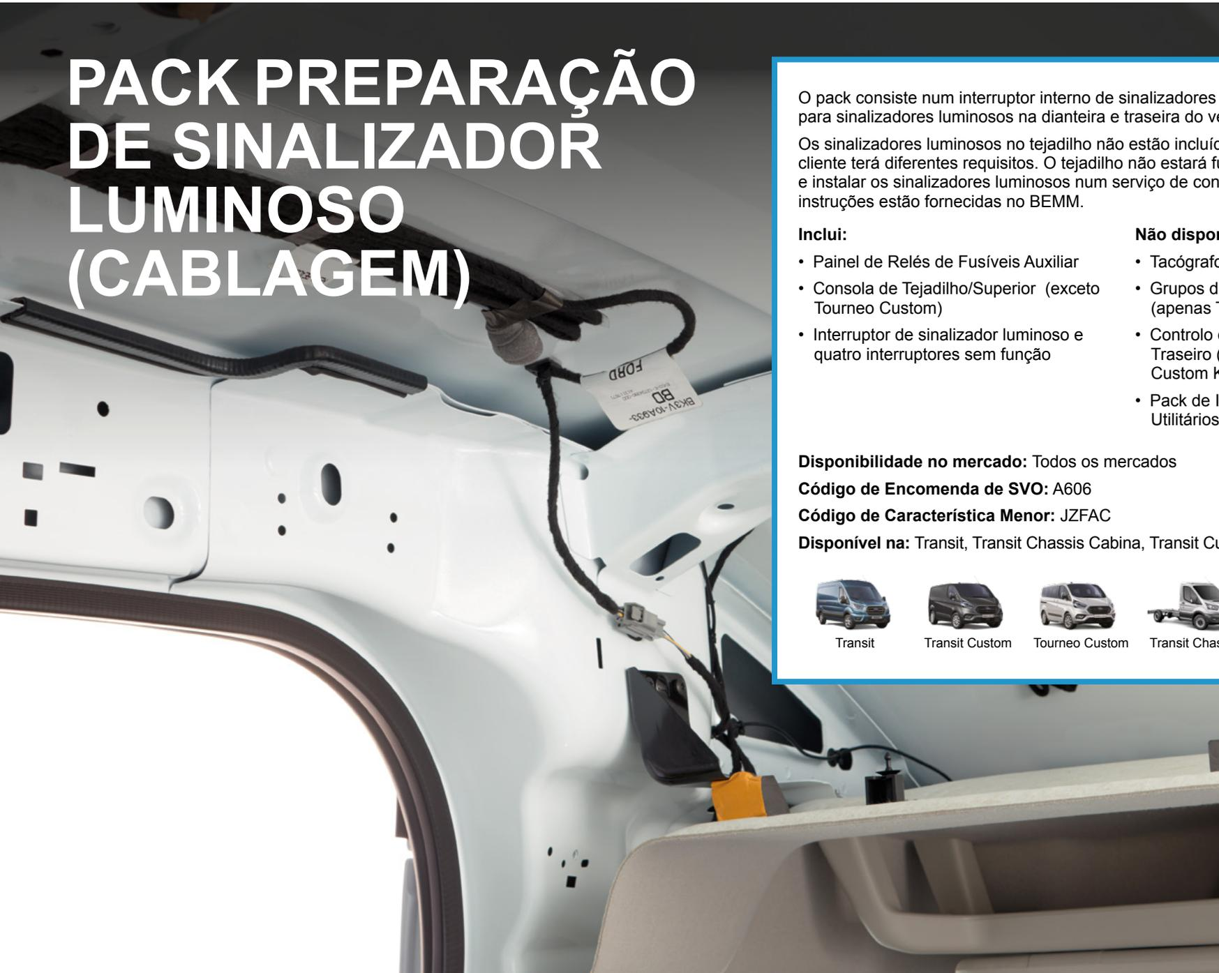
O pack consiste num interruptor interno de sinalizadores luminosos e em ligações elétricas para sinalizadores luminosos na dianteira e traseira do veículo.
