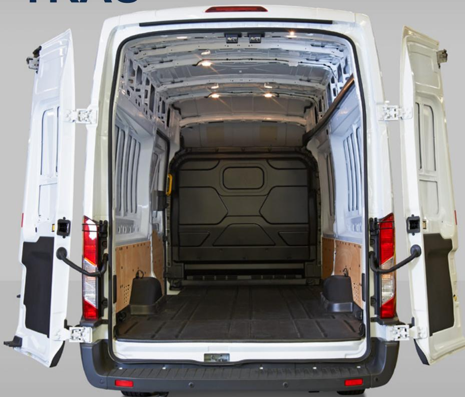
Esta opção minimiza a largura total do veículo quando se abrem as portas traseiras para um melhor acesso aos compartimentos de carga. Com fixações magnéticas, as portas ficam encostadas ao exterior do veículo quando abertas até ao máximo. Disponíveis na Transit L2\*, L3, L4.
