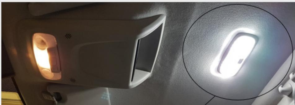
Esta característica foi incluída na opção de iluminação LED do espaço de carga e constitui uma atualização da iluminação LED da cabina de cerca de 500 lúmenes, uma vantagem para o operador que utiliza a cabina como escritório móvel.
