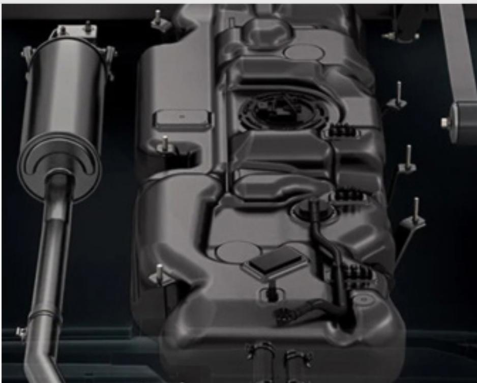
A Porta de Combustível Auxiliar proporciona uma tubagem e conector de combustível para facilitar a fixação em equipamento auxiliar, como, por exemplo, sistemas de aquecimento do mercado pós-venda. Está equipada de série com um conector fêmea TI LOCC QC 7.89; porém, recomenda-se a compra de um adaptador macho 7.89 correspondente para utilizar com o conector (fabricante: TI Automotive GmbH).
