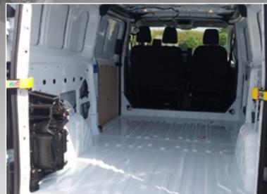
O Pack Ar Condicionado Traseiro para Refrigeração permite conversões de refrigeração personalizadas. Esta opção inclui a montagem de uma unidade de climatização no pilar D traseiro do lado esquerdo. Esta unidade não dispõe de tubagens nem de acabamentos. O serviço de conversão tem de instalar tubagens para direcionar o ar refrigerado conforme necessário. O serviço de conversão também tem de ocultar o equipamento de climatização no pilar D. (Veículo incompleto – Multifaseado)
