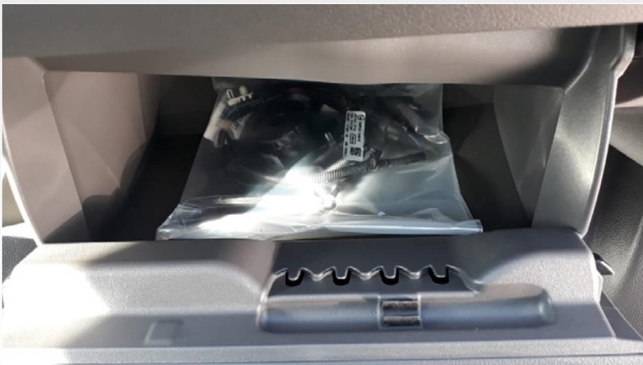
Esta opção permite ao cliente encomendar a peça do sinal sonoro e os respetivos cabos como uma unidade desmontada, dentro de um saco plástico, para o Chassis Skeletal.
