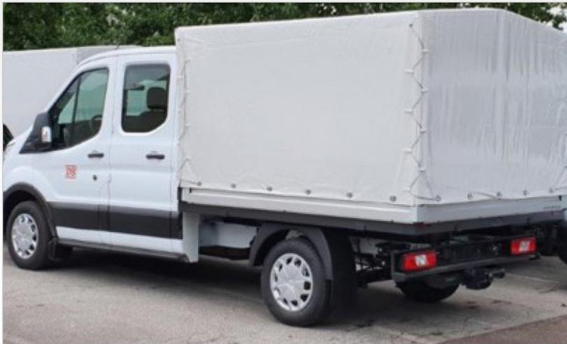
Esta opção inclui a montagem de um kit de encerado numa caixa Transit Chassis Cabina Dupla. O encerado cobre toda a área de carga. É fácil de abrir e fechar com ganchos e uma corda.
