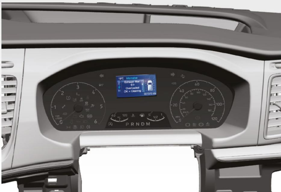
O Filtro de Partículas Diesel (DPF) ajuda a remover as partículas dos sistemas de escape dos motores a diesel.
