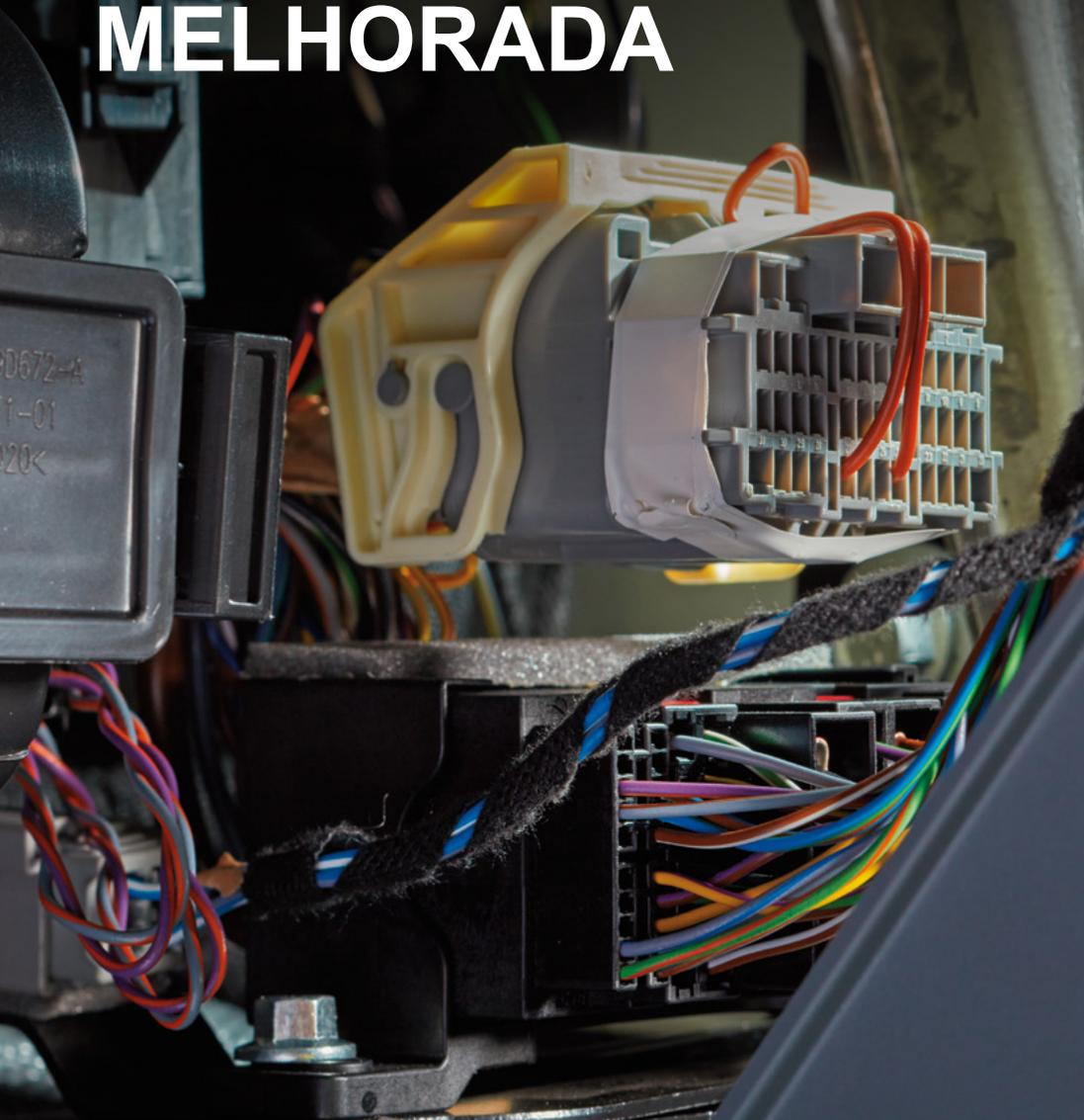
O pack Interface Eletrónica Melhorada proporciona uma conectividade abrangente a vários sinais elétricos do veículo. O conector está situado no painel de instrumentos por detrás do porta-luvas.
